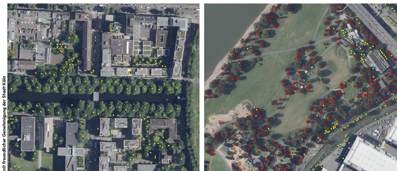
Abb. 2: Automatisch erkannte Einzelbäume sind mit Punkten markiert. Rot markierte Bäume sind Katasterbäumen zugeordnet, gelbe nicht
